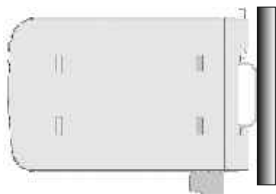
Rys. 3 Montaż na szynie TS-35 (DIN)
